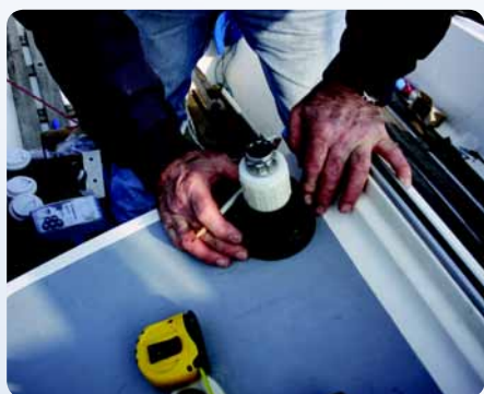
Déterminez le meilleur emplacement, marquez et percez des trous de 6 mm.
