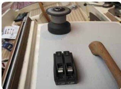
Position des bloqueurs sur le roof d'un Westerly Centaur.
