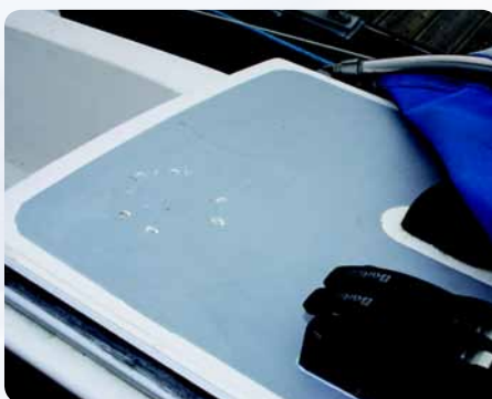
Mettez du mastic dans les trous ainsi que sur les filetages et la base du winch (surtout pas sur le mécanisme du winch).
